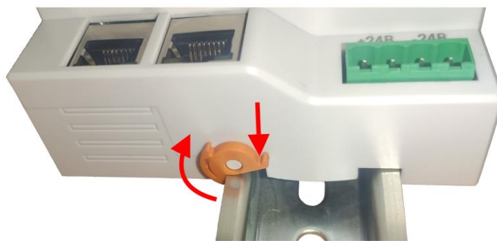
Рисунок 3-4 Снятие фиксации интерфейсного модуля
