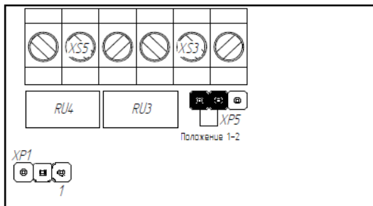
Рисунок 9 – Установка переключки терминирующего резистора
