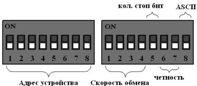
Рисунок 2 – Набор переключателей (все переключатели выключены)
