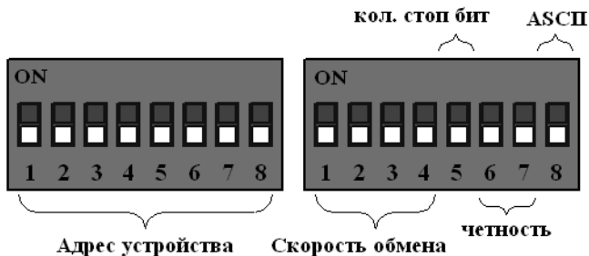
Рисунок 2 – Набор переключателей (все переключатели выключены)
